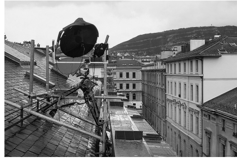
Vue du système de rotation de la caméra et du microphone hyper-directionnel Ansicht der Schwenkvorrichtung der Kamera und des Richtmikrofons View of the system for rotating the camera and the hyper-directional microphone
