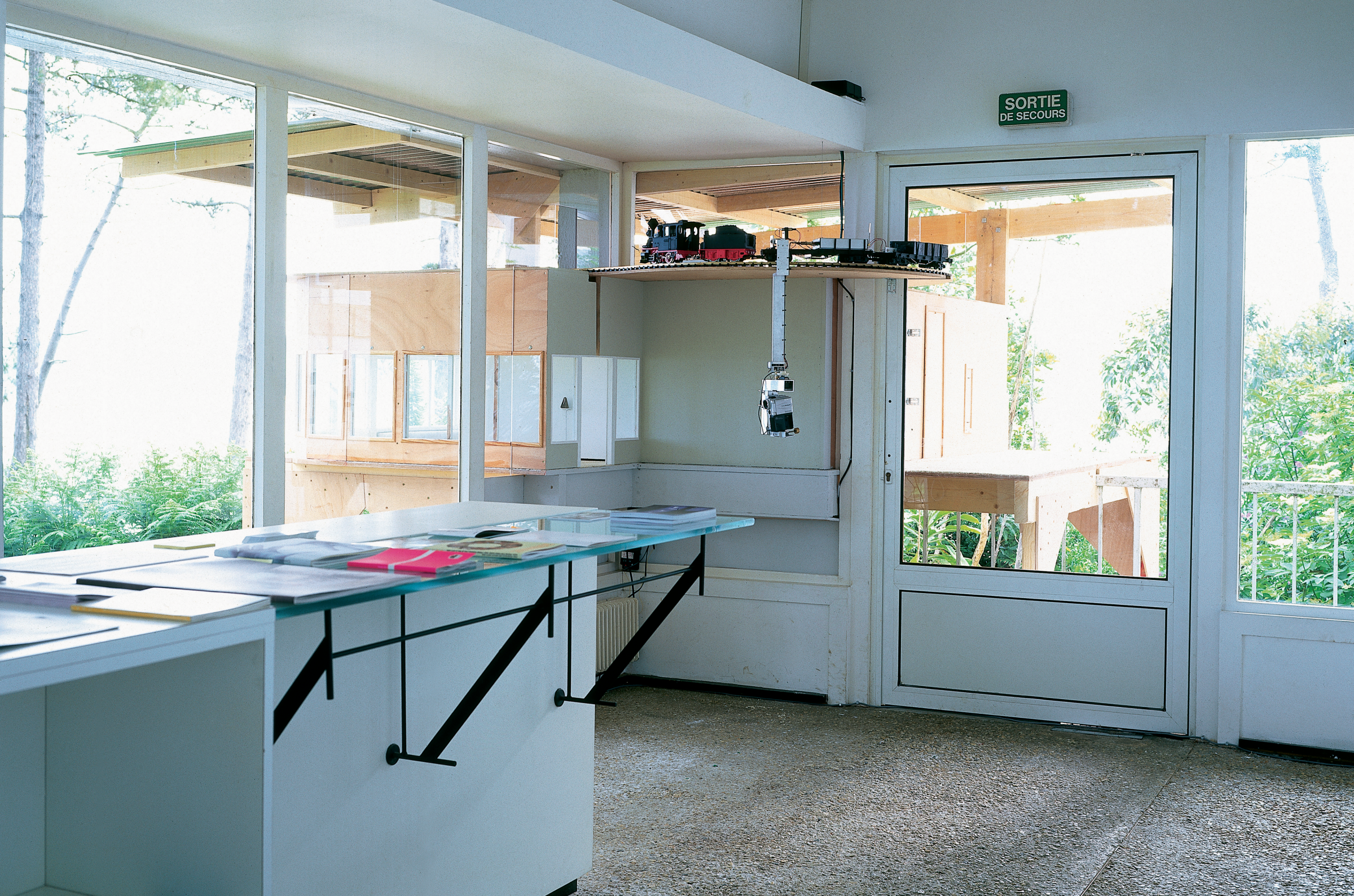
Vue du modèle réduit et du système de transport et de rotation de la caméra Ansicht des Modells sowie der Laufschiene und der Schwenkvorrichtung der Kamera View of the scale model and of the system for moving and rotating the camera
